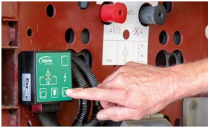
التشغيل مباشرة من وحدة التحكم مع مبین للميل وحماية ضد الحمل الزائد
