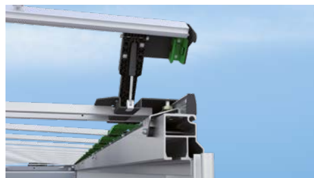
Odjštění portálového nosníku a vytažení krytu
