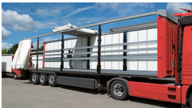
Öffnung des Daches und der Seitengardine am Beispiel des CS-Hybrid
