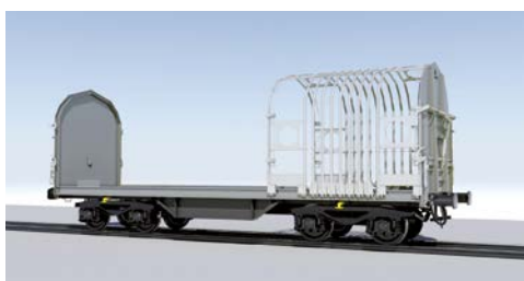
Railway SB - Beispiel: Shimmns Verdeck, geöffnet
