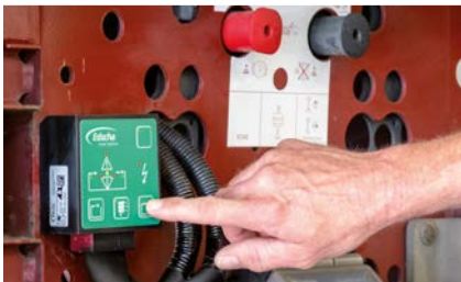
Bedienung direkt am Steuergerät mit Neigungsanzeige und Überlastschutz
