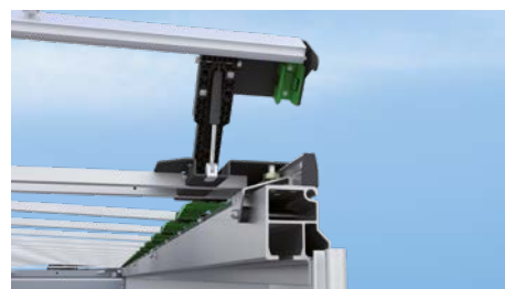
Portalbalken entriegeln und Verdeck ziehen
