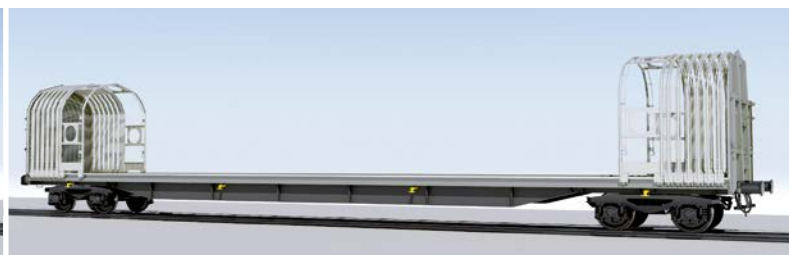
Railway SB · Ejemplo: Rils Diseño para cargas largas, abierta (en ambos lados)
