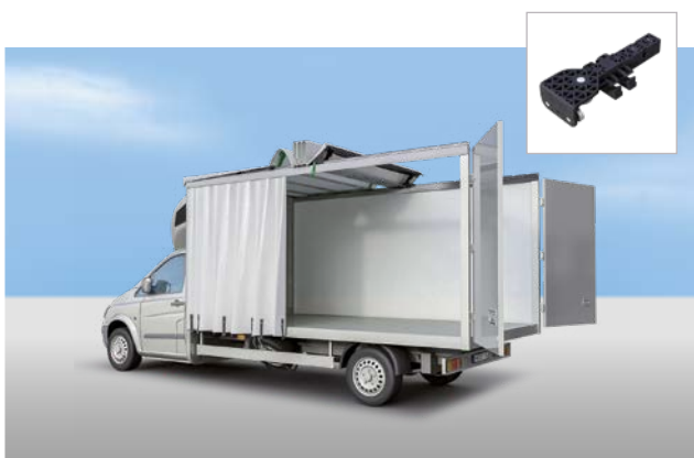
Compact Techo corredizo CurtainSider/Toldo completo
