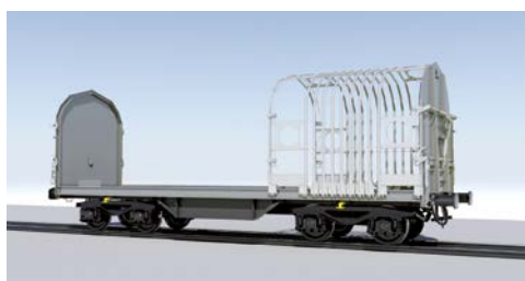
Railway SB - esempio: Shimmns Centinatura, aperta
