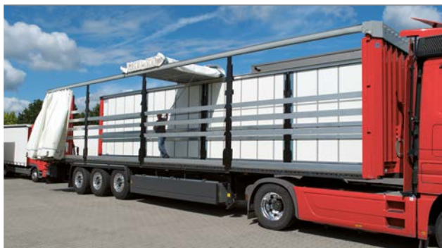
Apertura del tetto e del telo laterale usando l'esempio del CS-Hybrid
