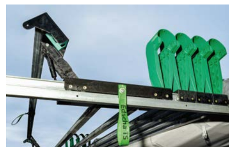
Robusti snodi con cinematica di ripiegamento ottimizzata
