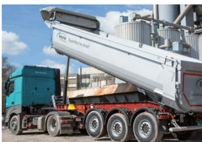
TipperRoof 開いた状態でティッピング中
