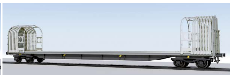
Railway SB - przykład: Wersja Rils do towarów podłużnych, otwarta (z dwóch stron)
