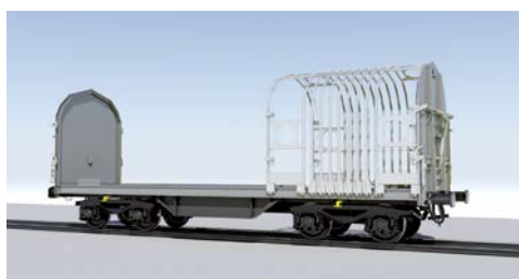
Railway SB - przykład: Dach Schimmns, otwarty
