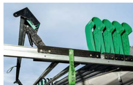
Wytrzymałe przeguby ze zoptymalizowaną kinematyką składania
