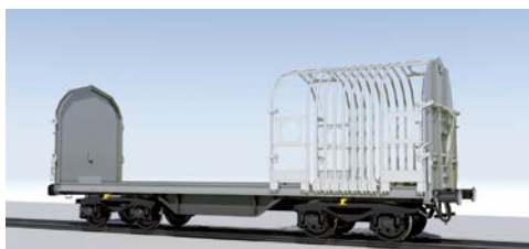
Пример Railway SB: складной верх вагона Shimms, открытый
