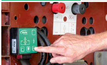
Управление прямо на блоке управления с индикатором наклона и защитой от перегрузки
