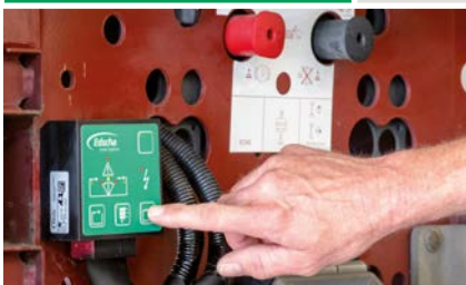
การใช้งานโดยตรงที่กล่องควบคุมพร้อมการแจ้งเตือนความเสียหายและการป้องกันการโหลดที่มากเกินไป
