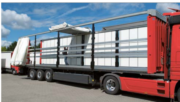
การเปิดหลังคาและม่านด้านข้าง โดยใช้ตัวอย่าง CS-Hybrid
