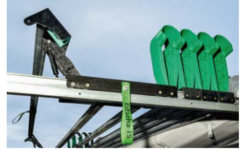
Optimize edilmiş katlama kinematiği sunan dayanıklı mafsallar
