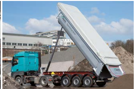
TipperRoof Kapalı şekilde boşaltma
