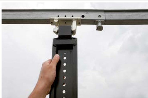
Edscha TS Topkupplung Edscha TS top coupling
