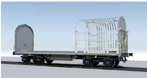
Railway SB · مثال: Shimmns الغطاء مفتوح
