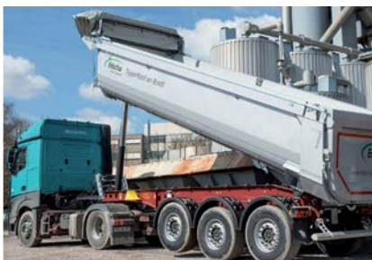
TipperRoof otevřít sklápění
