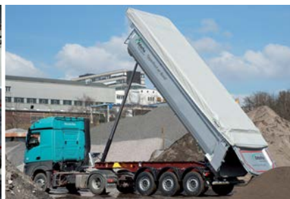
TipperRoof zavřít sklápění
