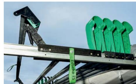
Robuste Gelenke mit optimierter Falt-Kinematik
