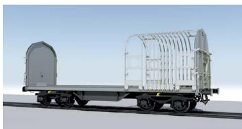
Railway SB • Exemple : Shimmns avec toit ouvert
