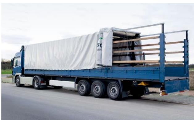
Operazione di apertura di un VP-Standard
