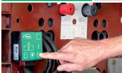
Gestione direttamente dall'apparecchio di controllo con indicazione dell'inclinazione e protezione da sovraccarichi
