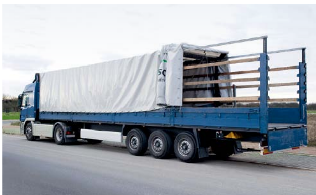
Proces otwierania na przykładzie VP-Standard
