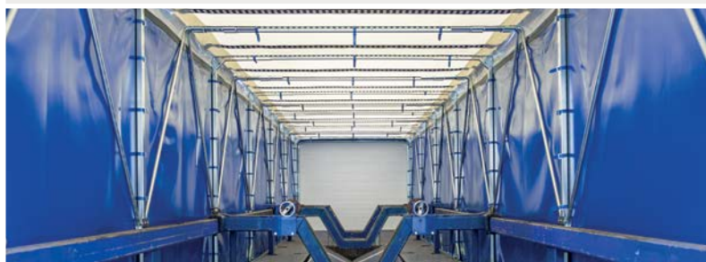
Zoptymalizowane wymiary w świetle i połączone składane wsporniki
