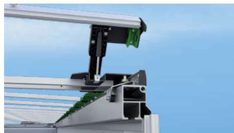
Odblokować belkę portalową i pociągnąć dach
