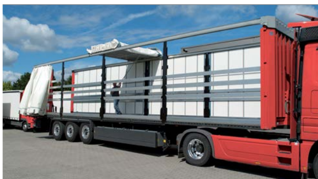
Otwieranie dachu i kurtyny bocznej na przykładzie CS-Hybrid
