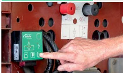
Operação diretamente a partir da unidade de comando com visor de inclinação e proteção contra carga em excesso
