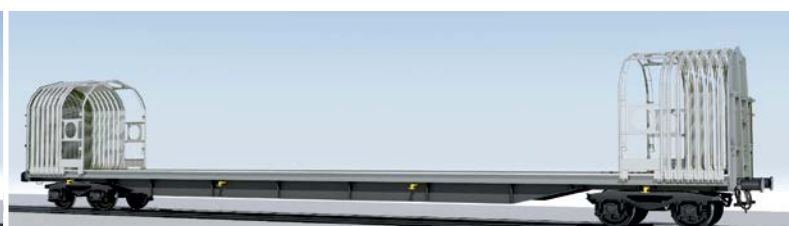
Пример Railway SB: модель Rils для длинного груза, открытая (с обеих сторон)
