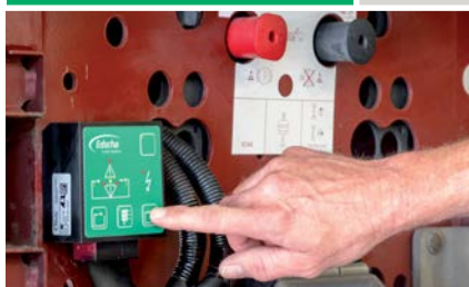
Manövrering direkt på styrenheten med luthningsdisplay och överbelastningsskydd
