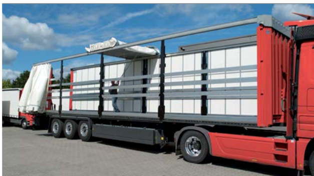
การเปิดหลังคาและม่านด้านข้าง โดยใช้ตัวอย่าง CS-Hybrid
