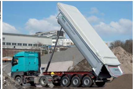
TipperRoof Kapalı şekilde boşaltma
