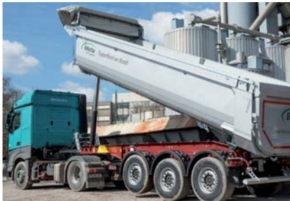
TipperRoof Açık şekilde boşaltma
