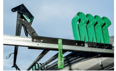
Optimize edilmiş katlama kinematiği sunan dayanıklı mafsallar
