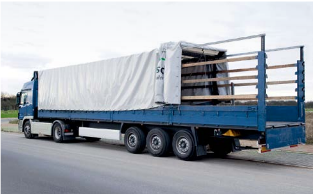
Komple tenteli tavan standardı örneğinde açılma işlemi
