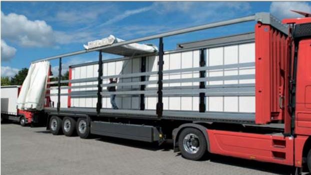
Tavanın ve yan perdenin açılması CS-Hybrid örneğini kullanarak
