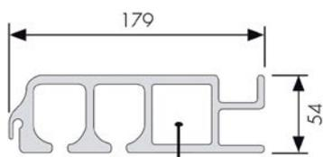
Kammer zur Aufnahme von Verstärkungsrohren
