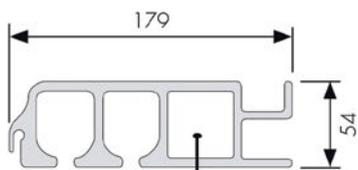
Kammer zur Aufnahme von Verstärkungsrohren
